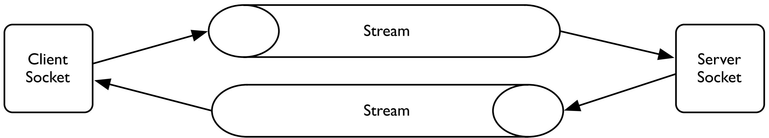
**Una connessione fornisce due stream con correzione di errore automatica**
